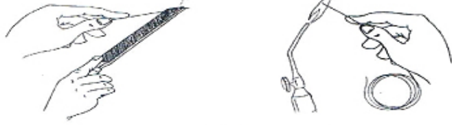
الشكل رقم: 08 (ب) يبرد طرف السلك
