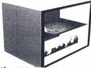
الشكل رقم: 39 وضع الحلية في الفرن لتثبيت الميناء
